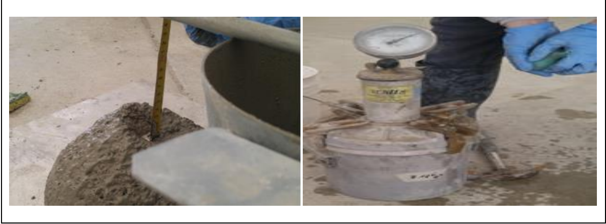
Figure D1.1 Air Content Test
